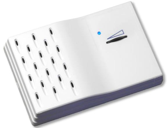
ADS-RH ist ein elektronischer Feuchtigkeitsensor mit einem kapazitiven Polymer-Sensor. Der Sensor ist mit einem Relaisausgang mit einstellbarer Schaltstufe und einem 0-10V Spannungsausgang ausgestattet. Die Messung ist regelmäßig nach 7s durchgeführt. Auf Grundlage dieser Messung ist es dann möglich die Lüftungs- und Klimaanlage sowie Rekuperatoren direkt steuern.
